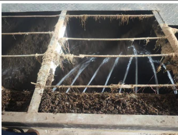
搅拌喷淋降尘
